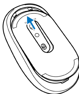
Figura 7. Recolocando a tampa da base
